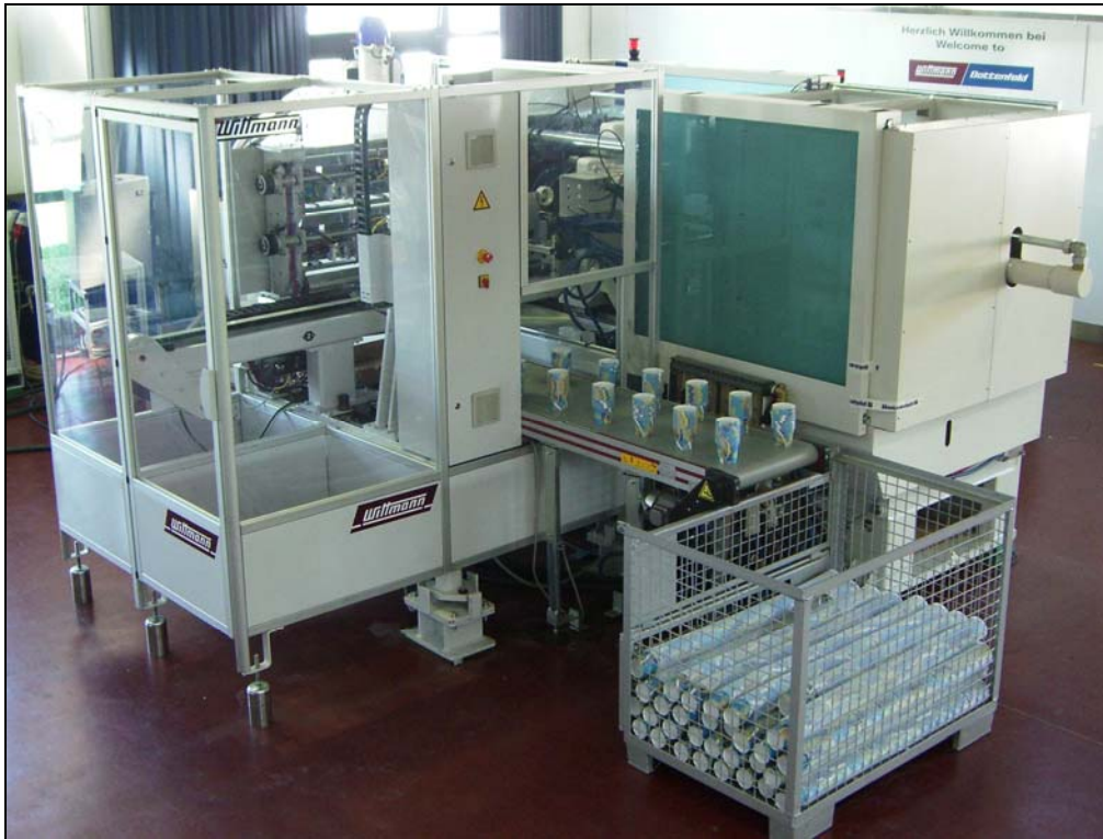
Abb. 1: Auf einer TM Xpress 270/1350 mit IML-Anwendung werden Becher (750 ml) gefertigt
