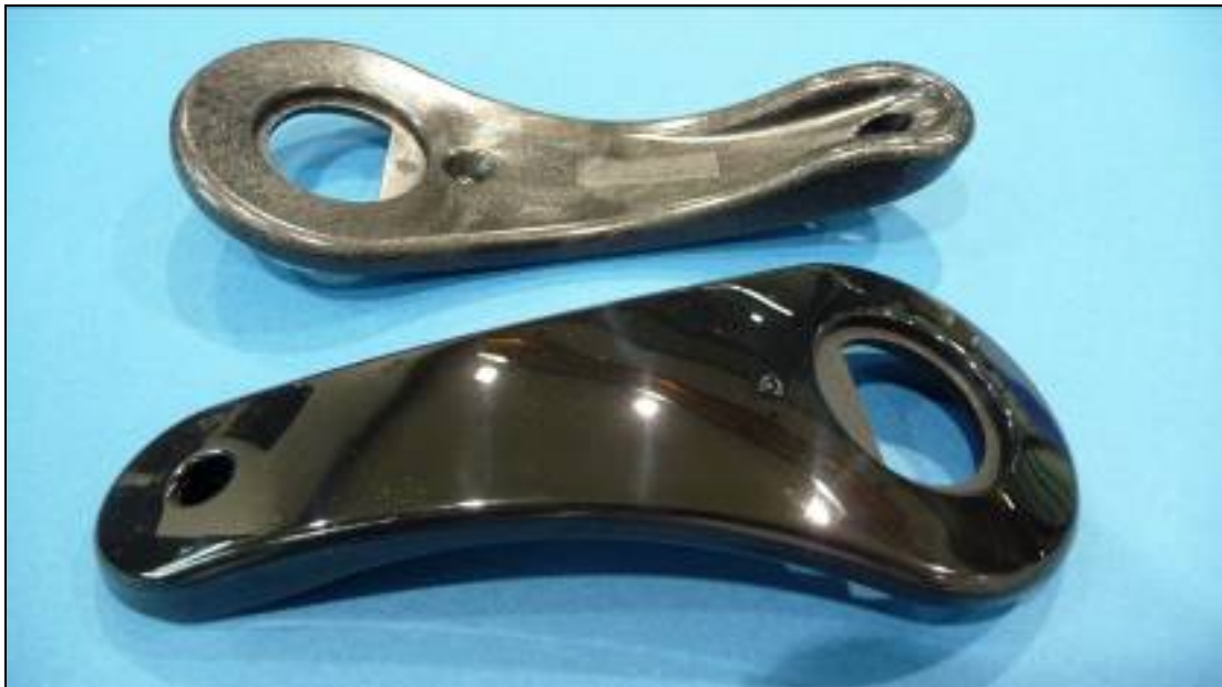
Abb. 1: Rückseite: Typische Oberflächenstruktur von geschäumten Formteilen Vorderseite: Hochglänzende Oberfläche des geschäumten Formteils
