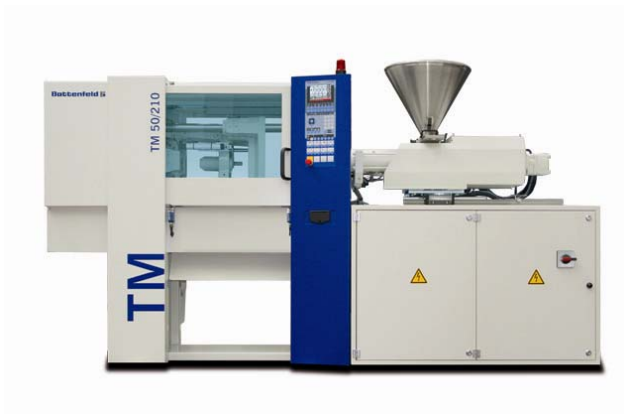
Auf einer TM 50/210 fertigt BATTENFELD einen Licht-Sockel aus Polystyrol
