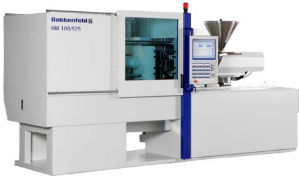
Auf einer HM 100/525 produziert BATTENFELD auf der Brasilplast in Airmouldtechnik einen Handtuchhalter aus Polycarbonat
