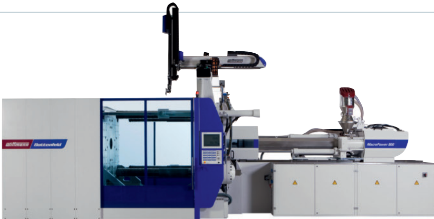
Die neue Großmaschinen-Baureihe MacroPower – das Premierenmodell mit 8000 kN Schließkraft – gilt Inhabern und Technikern des Unternehmens als Herzensangelegenheit
