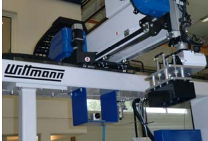
Abb. 7: Exakte Positionierung des Bausteines vor der IR Kamera
